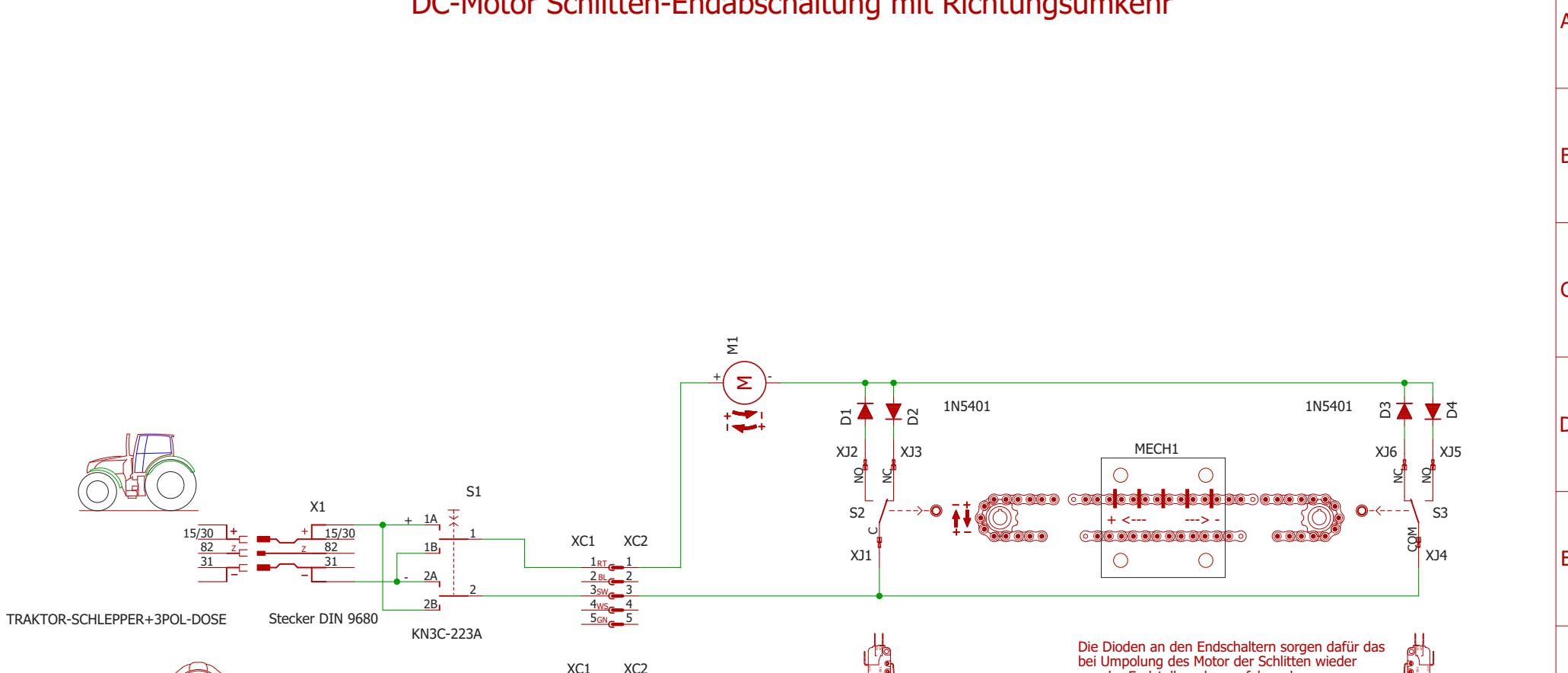
Die Dioden an den Endschaltern sorgen dafür das bei Umpolung des Motor der Schlitten wieder aus der Endstellung herausfahren kann.
