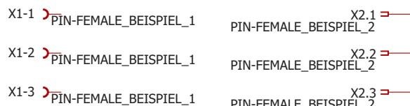
In der Regel ist bei Steckern mit Einzelgates pro PIN der Gate-Name gleich der PIN-Name, das heißt, am PIN werden sowohl die Anzeige des PIN-Namen so wie die Anzeige des PAD-Namen abgeschaltet. Beim Platzieren der Gates im Device vergibt man dann als Gate-Namen .1 .2 .3 bzw. -1 -2 -3 oder auch \_1 \_2 \_3
